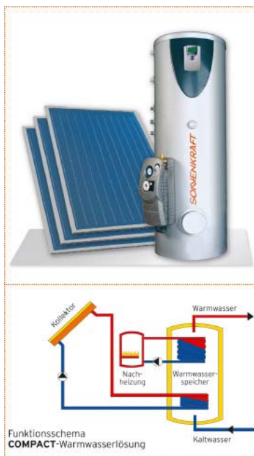
Slika 26: Shema solarnega sistema
